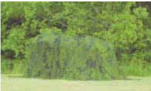
Позашляховик, вкритий маскувальною сіткою, що вбирає ІЧ
