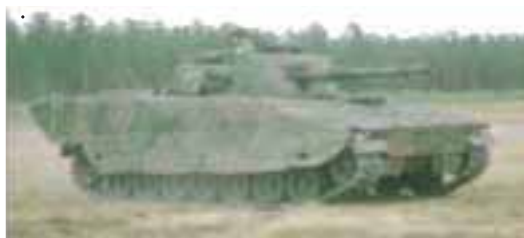
БМП 90 з прикладом фіксованого додаткового маскування
