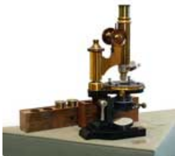
Рисунок 3 – Первый световой микроскоп с полевой линзой, микрометрическим винтом и зеркалом [19]
