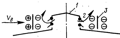
Рис. 6.15. Незадуваемый фонарь с ветроотбойными щитами:
