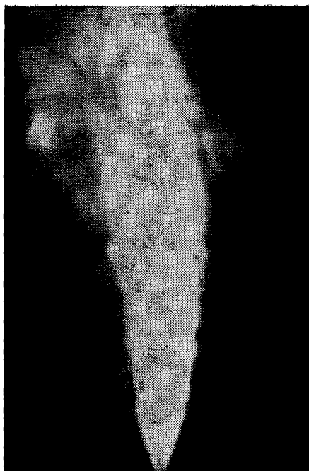
Дольного сечений турбулентной струи: видны вихри; б, г — большая экспозиция, границы струй четкие
