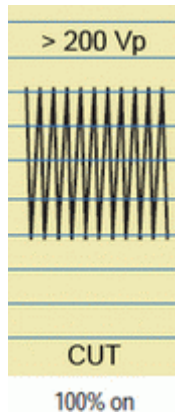
Рис. 22. Режущая форма волны [109]
