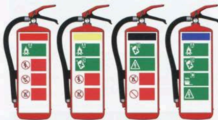
Маркировка на огнетушителях (в Европе: красный = вода, желтый = пена, черный = двуокись углерода, синий = порошок)
