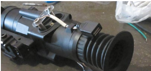
6. Заводим кабель приёма питания в проушину на корпусе прицела.
