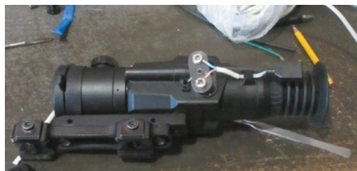
5. Припаиваем к шинам провода от USB-разъёма.
