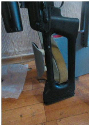
Жёсткий подщёчник из ПВХ трубы на проставках.
