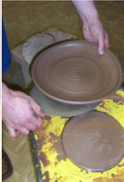
Снятие готовой тарелки с помощью лопатки-шпателя
