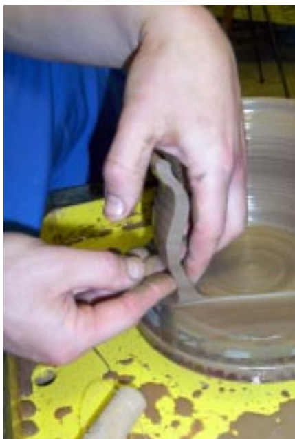
Правильное положение рук при вытягивании стенки изделия
