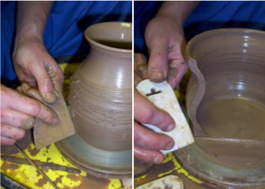
Проточка низа сосуда с помощью шаблона
