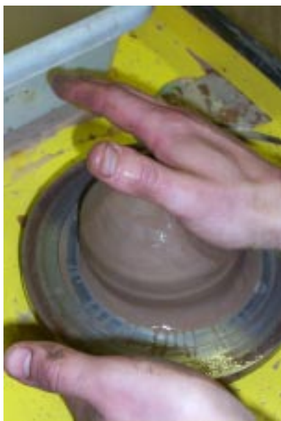
Боковой удар ладонью справа – для децентровки
