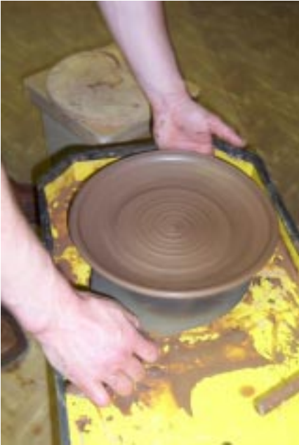
Снятие готовой тарелки с помощью лопатки-шпателя
