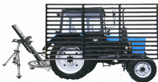
120-мм миномет на навесном устройстве трактора
