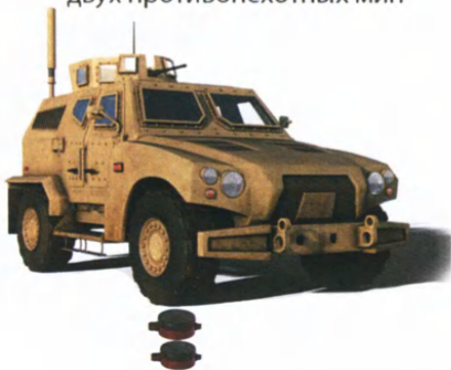
Вариант 1. Тандемная установка двух противопехотных мин
