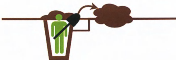
Фаза 2. Полная выборка грунта под спальное место
