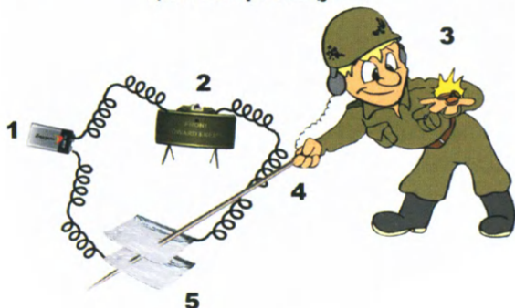
Мина-ловушка, рассчитанная на замыкание датчиков цели сапёрным щупом
